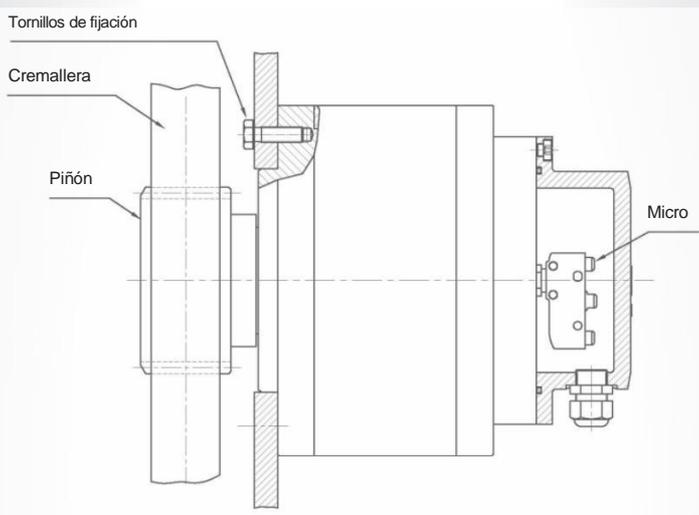
La unidad ha de **fijarse sólidamente a la estructura de la plataforma** de tal forma que su piñón quede perfectamente centrado y engranado a la cremallera. Una vez montada la unidad conectar los cables al conector del micro. Éste se encuentra en posición de normalmente cerrado.
